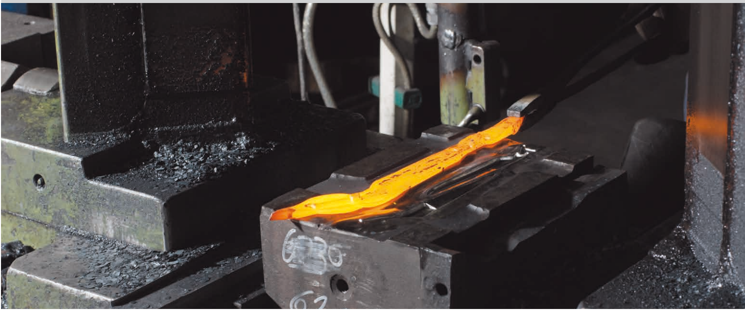
Die Spaltstücke werden vom Schmied am Fallhammer zu einem Scherenrohling warm geschmiedet.
